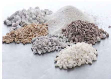
Figure 2: Photo de diverses variétés de granulats
