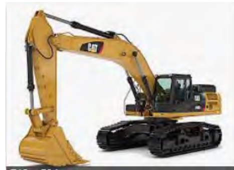
Pelle hydraulique excavatrice
