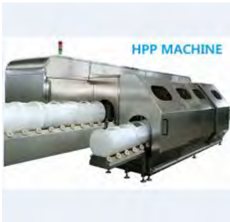
Figure 5: machine de pasteurisation à froid
